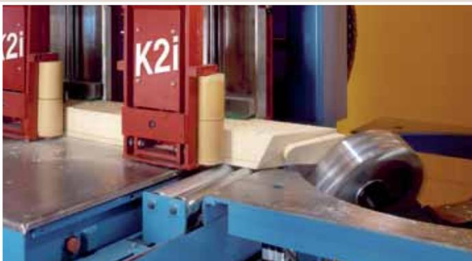
Le travi vengono tagliate e lavorate secondo i disegni costruttivi di dettaglio in un impianto di lavorazione completamente automatico a controllo numerico che riceve le informazioni necessarie direttamente in forma digitale da parte dell'Ufficio Tecnico.
